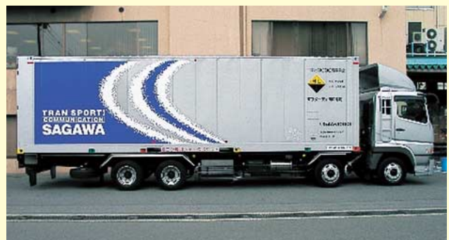
「スーパーレールカーゴ」用に開発されたコンテナトラック
